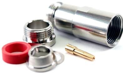
N разъемы разработаны П.Нэйлом из Bell Labs и являются первыми коннекторами, наиболее полно отвечающим требованиям СВЧ диапазона. Разъемы серии N предназначенные для сопротивления 50 Ом, могут быть использованы в довольно большом подборе сопротивлений. Они пригодны для сопротивления 75 Ом, хотя не взаимозаменяемы с моделями стандарта 50 Ом. Обычно выпускаются с импедансом 50 Ом и работают до 11 ГГц. Некоторые версии могут иметь граничную частоту до 18 ГГц.
