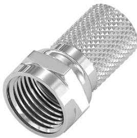
F разъемы - разработаны для телевизионного оборудования. Самые дешёвые на сегодня ВЧ разъемы, использующие центральную жилу кабеля непосредственно для соединения. Работают до частот 1200 МГц, с кабелями диаметром до 7 мм. Выпускаются штекеры, гнезда, переходники.
