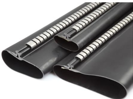
Термоусаживаемые кожухи с металлическими крепежными скобами и клеевым слоем предназначены для восстановления внешней оболочки высоковольтных кабелей. Кожух обеспечивает хорошую герметизацию, изоляцию и водостойкость мест повреждения оболочки кабеля. Усиливает механическую прочность в месте повреждения внешней оболочки кабеля.
