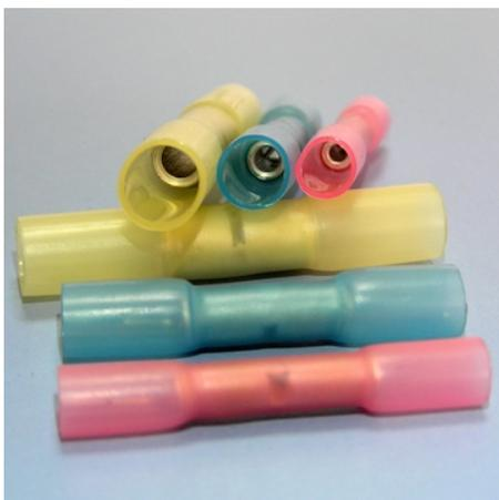
Термоусаживаемая соединительная гильза из полиэтилена с адгезивным слоем (под обжим). Состоит из термоусаживаемой трубки, изготовленной из полиэтилена высокой плотности (HDPE) с нанесенным на внутреннюю поверхность термоплавким клеем из полиамида (РА, Nylon).
