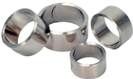
Немагнитные роликовые пружины постоянного давления используются в составе соединительных и концевых муфт для монтажа провода заземления к металлической оболочке и проволочной броне кабеля — без применения пайки. Использование пружин исключает риск повреждения бумажной изоляции под алюминиевой оболочкой, характерный для использования припоя марки «А».
