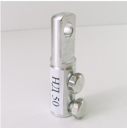
Наконечники болтовые - предназначены для оконцевания токопроводящих жил сечением от 25 до 240 мм.кв. на напряжение до 35 кВ. Крепление наконечника на жиле осуществляется методом завинчивания болтов с шестигранной головкой, которая срывается при достижении заданного усилия, обеспечивая надежное соединение и установленный согласно ГОСТ 17441-84 уровень токопроводности. Изготавливаются из дюралюминиевых сплавов марки В95 и Д16Т1.
