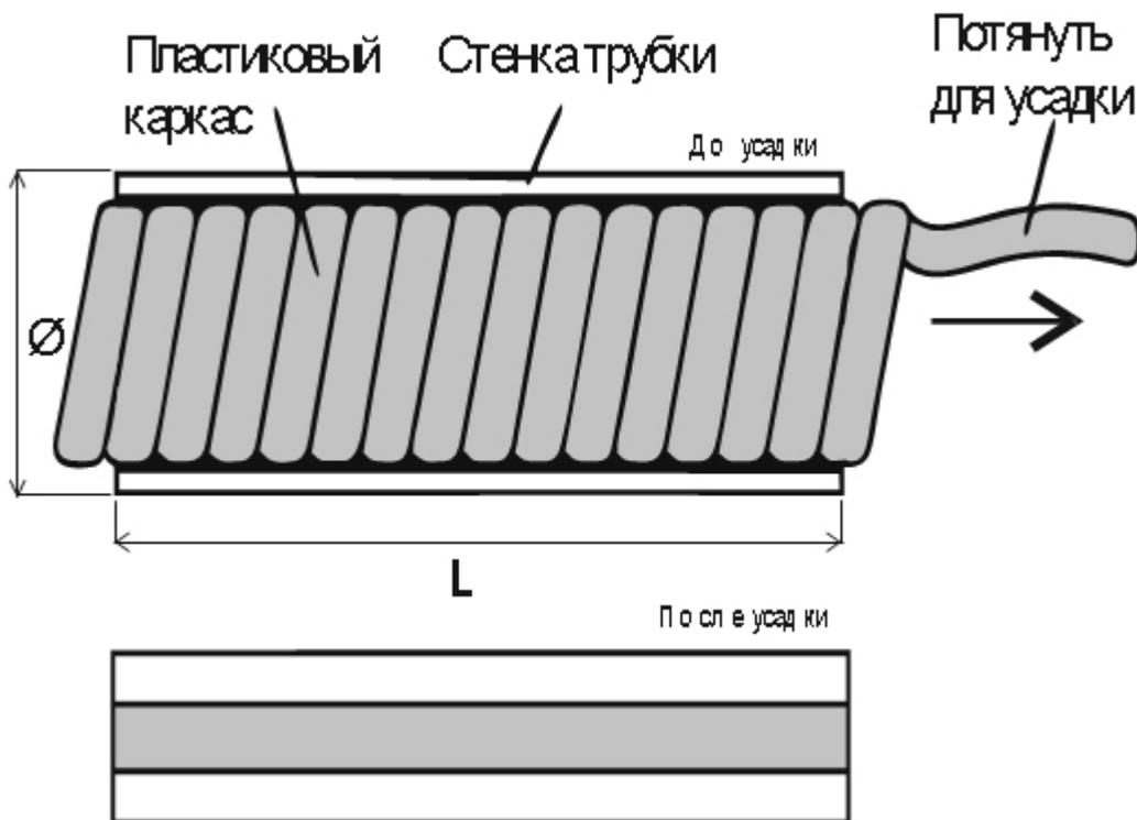
CST EPDM — трубка холодной усадки из EPDM, собранная на съемный пластиковый сердечник (пластиковый корд).
